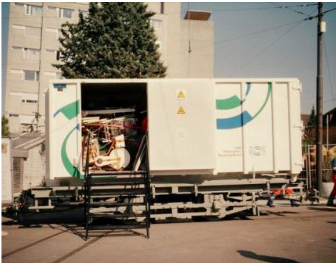
Rys. 6. Kontener Cargo-Tram załadowany ponadgabarytowymi odpadkami stojący w jednym z punktów odbioru w Zürichu
