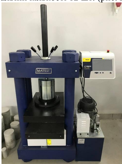
Рис. 1 Випробувальна машина для стискання бетону
